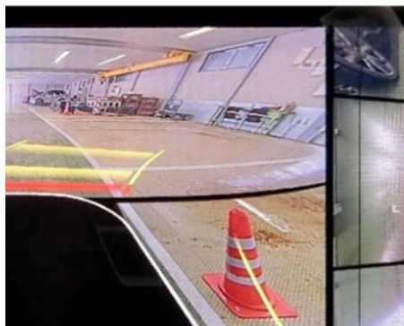
Caméra 360° avec fonction « See-through View »
