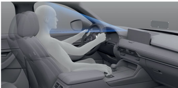
Système de personnalisation du siège conducteur par reconnaissance faciale
